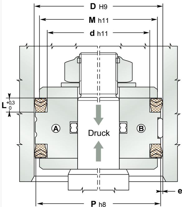
Gehäuseführung mit Führungsringen
